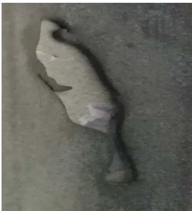
Рис. 4. Незалив пера лопатки со стороны корыта
