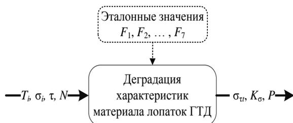
Рис. 1. Модель деградации характеристик материала лопатки ГТД
