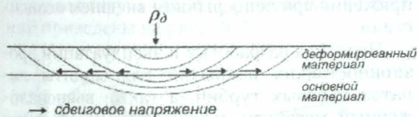
Рис. 3. Схема возникновения растягивающих напряжений в поверхностном слое материала
