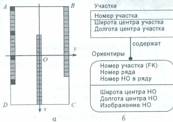
Рис. 5. База данных наземных ориентиров: а — расположение наземных ориентиров на участке; б — структура базы данных наземных ориентиров
