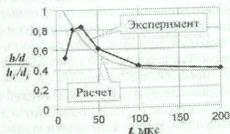
Рис. 4. Зависимость отношения h/d к h_i/d_i от длительности импульса (условия эксперимента см. рис. 3)
