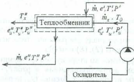
Рис. 7. Принципиальная схема для оценки потерь эксергии в теплообменнике охладителя: 1 — насос или вентилятор
