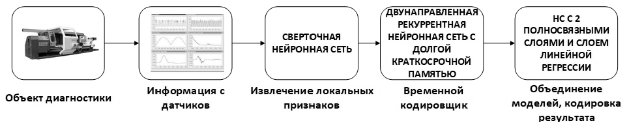
Рис. 2. Архитектура сверточной рекуррентной нейронной сети с долгой краткосрочной памятью
