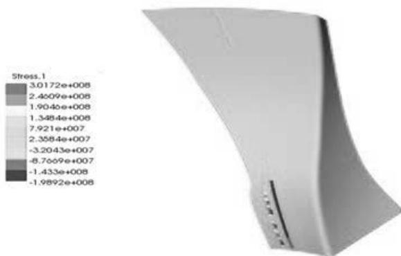
**Рис. 8.** Напряжения  $\sigma_{33}$  перпендикулярно плоскости 1-го слоя малой лопатки рабочего колеса
