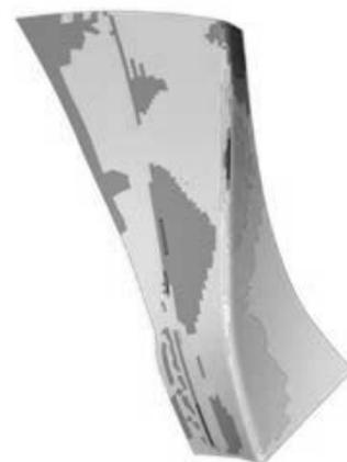
**Рис. 9.** Напряжения  $\tau_{12}$  в плоскости 1-го слоя малой лопатки рабочего колеса
