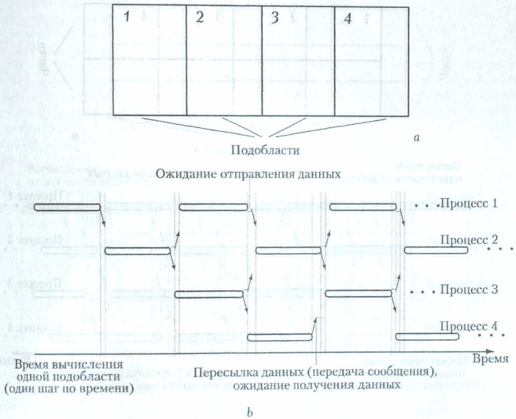
Рис. 2. Расчетная область (а) и пространственно-временная диаграмма (б) для случая простой декомпозиции по топологии «линейка»
