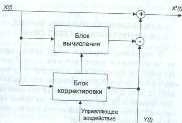
Рис. 3. Схема адаптивного управления дополнительным информационным потоком
