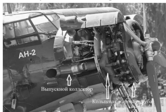
Рис. 6. Общий вид выхлопной системы двигателя АШ-62ИР на самолете АН-2
