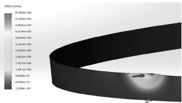
Рис. 2. Эпюра перемещений в области точки воздействия силы резания на обрабатываемую деталь
