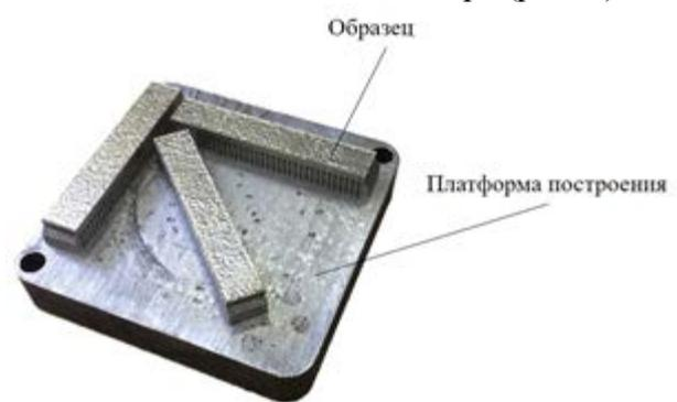
Рис. 4. Изготовленные калибровочные образцы
