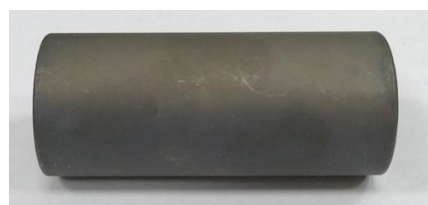
Рис. 4. Втулка, подвергнутая термообработке
