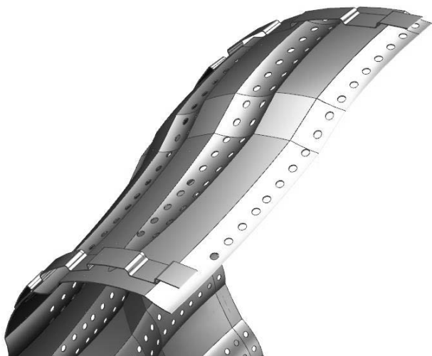
Рис. 8. 3D-твердотельная геометрическая модель первой секции теплозащитного (антивибрационного) экрана ФК ТРДДФсм
