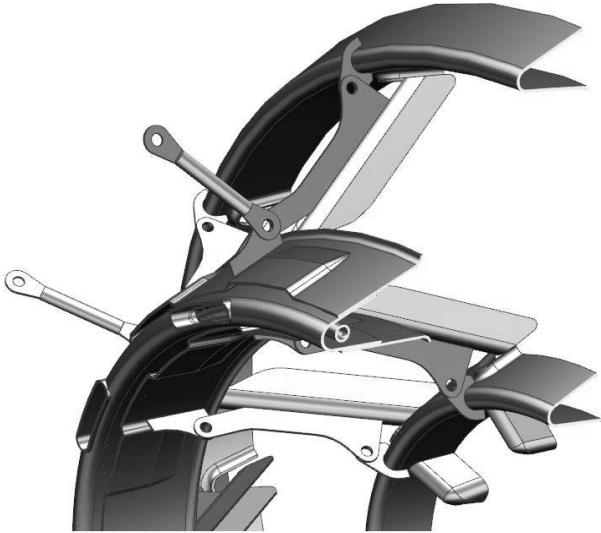
Рис. 5. 3D-твердотельная геометрическая модель блока стабилизаторов пламени ФК ТРДДФсм
