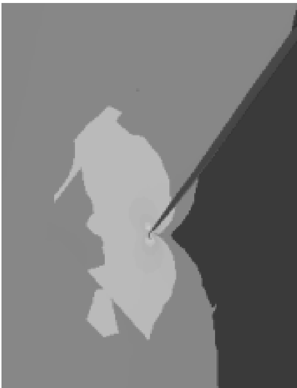
Рис. 11. Поля напряжений в вершине трещины
