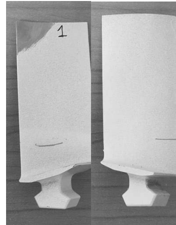
Рис. 15. Разрушение лопатки компрессора из жаропрочного титанового сплава ВТ-6
