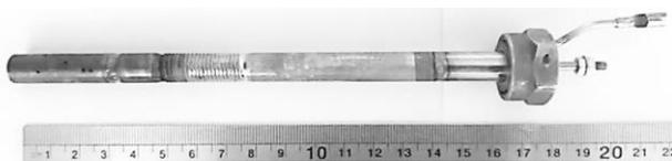
Рис. 6. Окончательный вариант свечи накаливания
