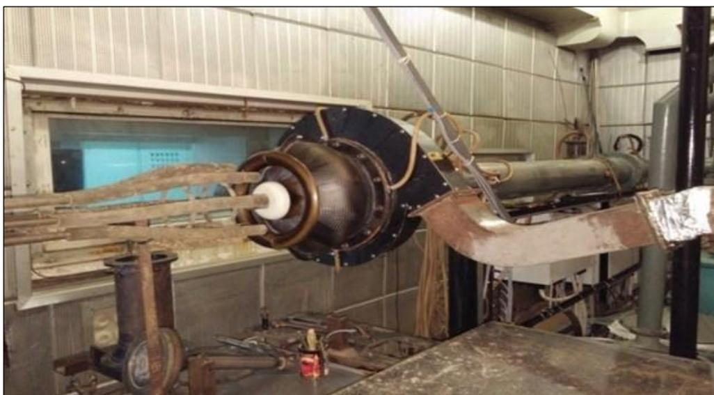
Рис. 1. Общий вид собранного ПЗУ с «улиткой» на испытательном стенде
