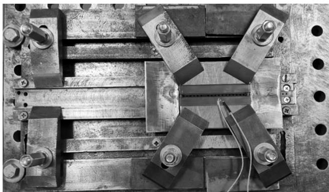
Рис. 5. Сварочная оснастка с медной подкладкой и клавишными прижимами
