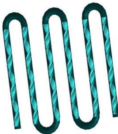
**Рис. 3.** 3D-модель трубки модуля воздухо-воздушного теплообменника с установленными ленточными завихрителями для интенсификации теплообмена
