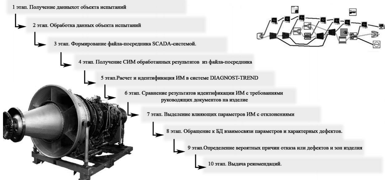
Рис. 3. Методика диагностирования газотурбинных установок на базе SCADA-технологий и имитационного моделирования
