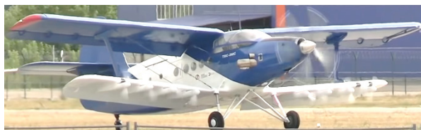
Рис. 16. Самолет ТВС-2МС с распределенной ЭСУ на нижнем крыле
