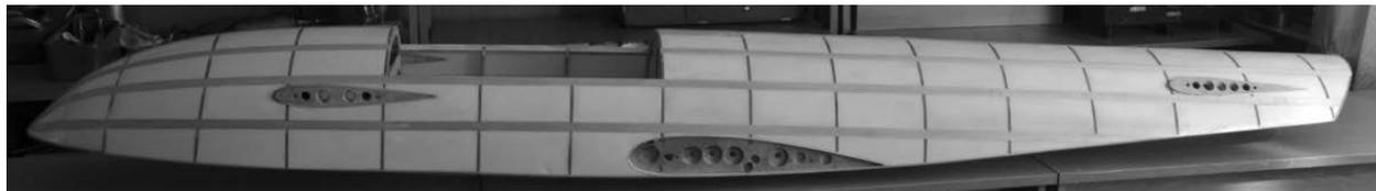
Рис. 11. Обшивка силового каркаса фюзеляжа разрабатываемого БПЛА
