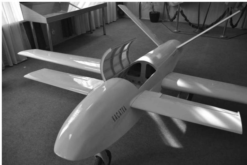
Рис. 12. Планер разрабатываемого БПЛА с техническим отсеком
