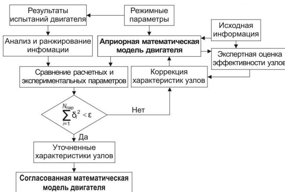
Рис. 1. Упрощенная схема согласования ММД с результатами испытаний
