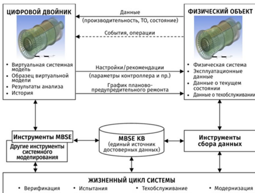
Рис. 2. Концепция цифрового двойника в структуре модельно-ориентированного системного проектирования
