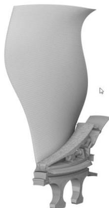
**Рис. 3.** Сеточная модель сектора диска вентилятора с рабочей лопаткой
