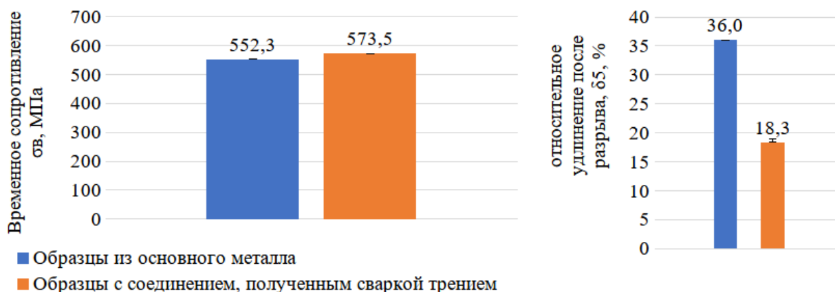
Рис. 5. Результаты испытаний на растяжение опытных образцов
