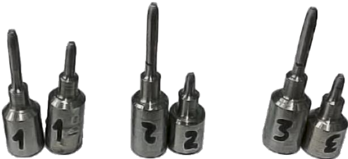
Рис. 4. Сварные образцы после разрушения
