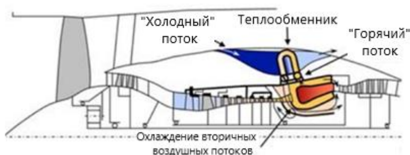
Рис. 13. Воздухо-воздушный теплообменник, интегрированный во внешний контур ТРДД
