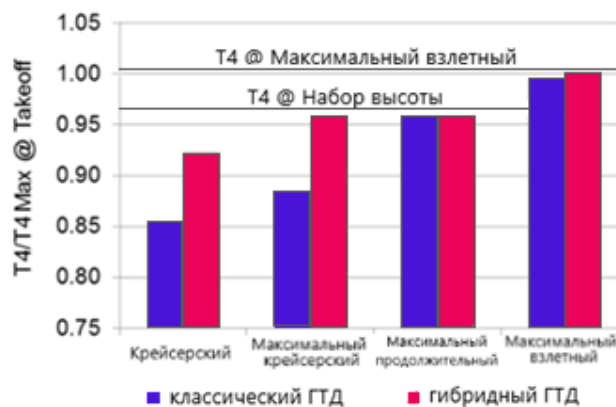
Рис. 5. Зависимость максимальной температуры от режима работы двигателя
