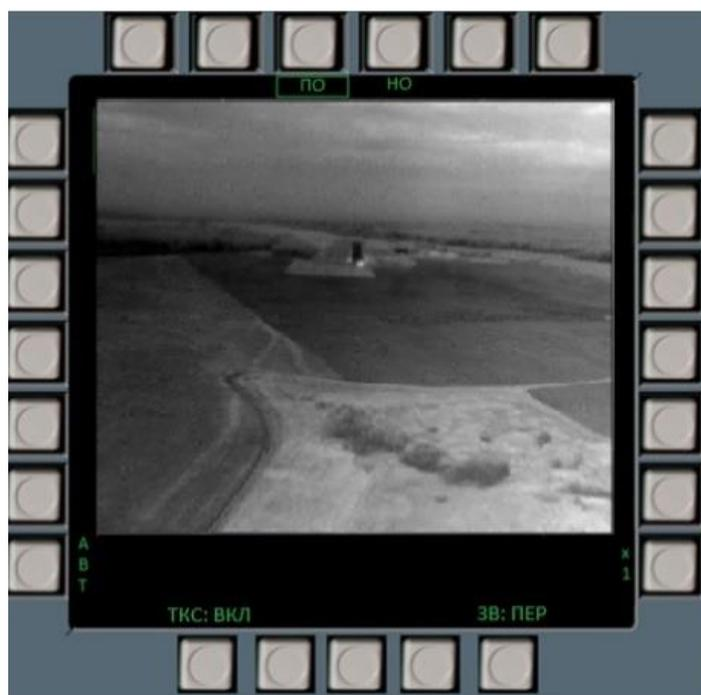
Рис. 5. Режим автоматического комплексирования спектральных каналов переднего обзора
