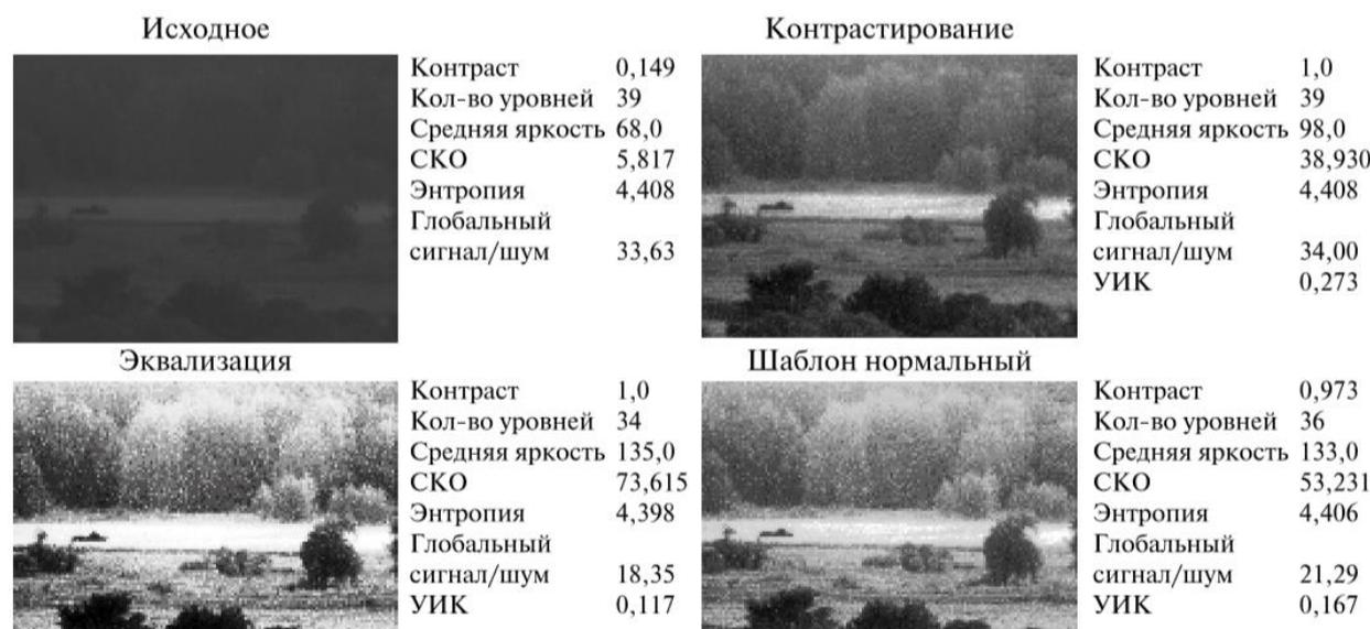
Рис. 3. Примеры обработки изображений разными операторами повышения контраста и численные характеристики изображений
