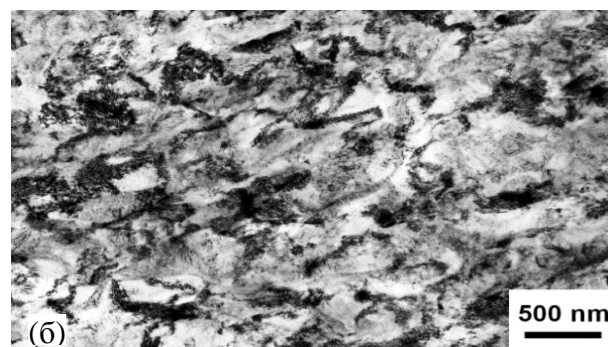
Рис. 1. Изображения микроструктуры УМЗ сплава ВТ6: а – в исходном состоянии; б – в ультрамелкозернистом состоянии. Растровая электронная микроскопия
