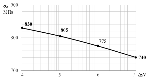
Рис. 3. Кривая усталости для наноструктурного титанового сплава Ti-6Al-4V
