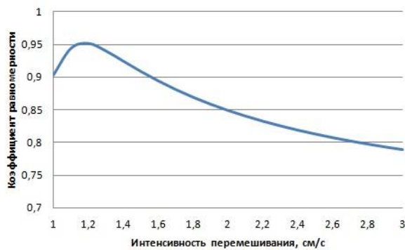
Рис. 3. График зависимости коэффициента равномерности от интенсивности перемешивания электролита
