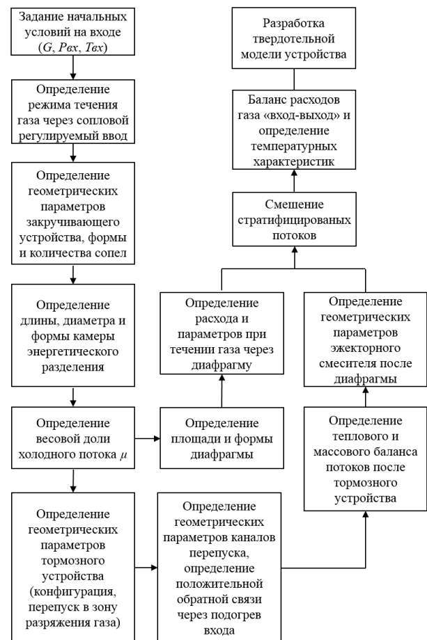
Рис. 3. Структурная схема построения твердотельной модели и алгоритма расчета параметров газа по тракту КВРД
