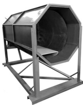
Рис. 4. Стенд для определения аэродинамических параметров посторонних предметов: а – внешний вид; б – рабочая область
