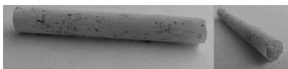
Рис. 3. Образец керамического слоя ТЗП толщиной 50 мкм для определения его КТР
