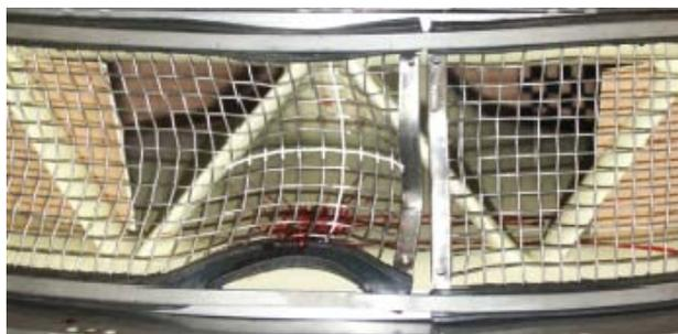
**Рис. 9.** Повреждение сетки при забросе птицы массой 0,35 кг
