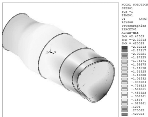
Рис. 9. Несимметричная деформация корпусов в районе задней подвески
