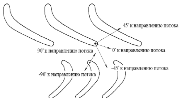
Рис. 1. Схема подвода топлива в межлопаточный канал турбины
