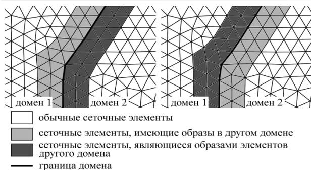
Рис. 1. Поле фиктивных сеточных элементов
