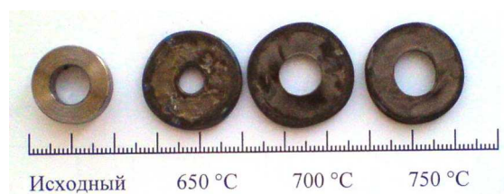
Рис. 7. Внешний вид кольцевых образцов, испытанных при различных температурах
