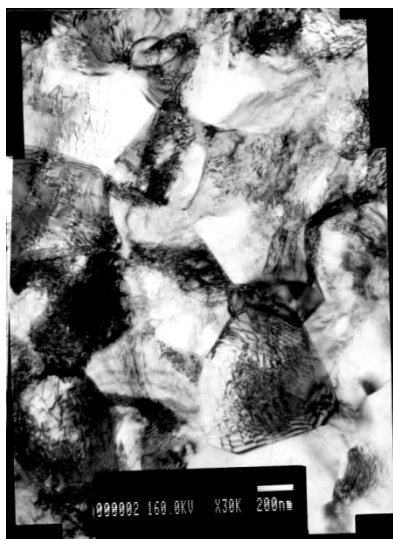
Рис. 5. Структура заготовки послековки и кузнечной протяжки: а – оптическая, б – электронная микроскопия
