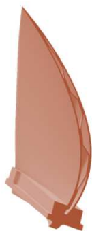
Рис. 1. Общий вид полую лопатки с сечением по диагонали от кромки до башмака
