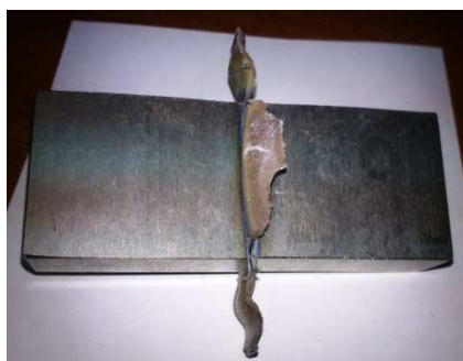
Рис. 1. Внешней вид детали, полученной линейной сваркой трением
