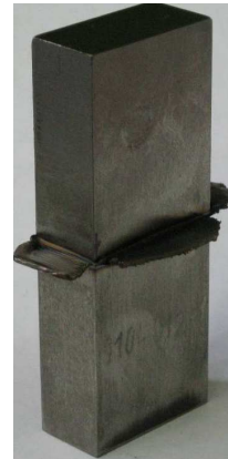
Рис. 3. Фотография деталей из ВТ6 и ВТ8-1, сваренных между собой
