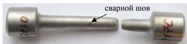
Рис. 1. Образец с цилиндрической формой рабочего участка, вырезанный из сварного соединения после испытаний на растяжение
