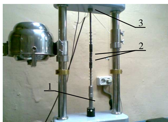
Рис. 2. Машина с вертикальным расположением траверсы, где 1 – траверса, 2 – захваты, в которых закрепляется образец, 3 – датчик усилия
