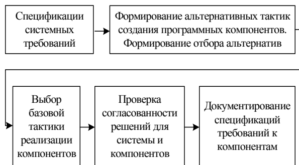
Рис. 4. Логическая структура процесса формирования спецификаций компонентов программной системы
