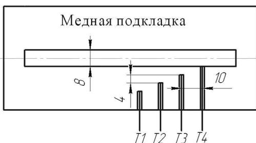
Рис. 4. Схема установки термопар в медную подкладку
