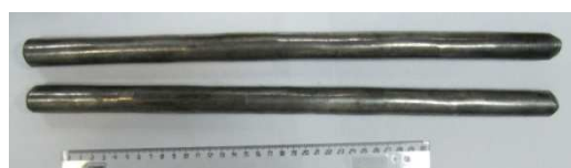
Рис. 2. Внешний вид УМЗ образцов сплава АК4-1 после РКУП при температуре 160 \text{ }^\circ\text{C} и дополнительной протяжке
