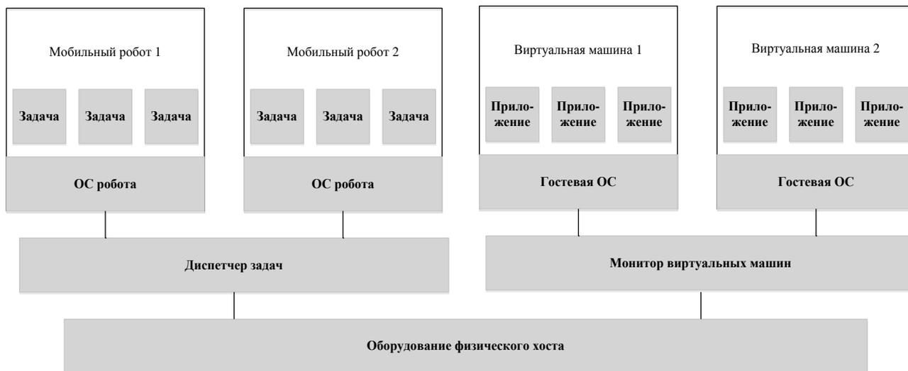
Рис. 2. Схема доступа к виртуальным информационным ресурсам через облачные технологии
