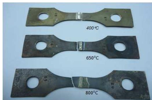
**Рис. 4.** Внешний вид образцов из стали 12Х18Н10Т, паяных припоем ВПр50 после испытания при 400, 650 и 800 °С
